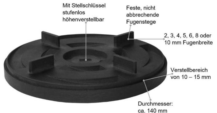
Abbildung 1: RT-V Dreh-Stelzlager, Kunststoff, schwarz, verstellbar von 10-15mm
